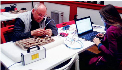
Analyse des couleurs au spectromètre portable Thorlabs
